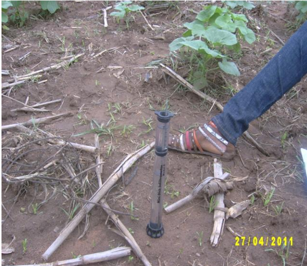
Plate 2. Mini disk infiltrometer
